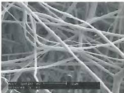
Вверху: СЭМ фотографии нановолоконного материала до стерилизации гамма-облучением. Внизу: СЭМ фотография нановолокон после стерилизации гамма-облучением (28kGy).
